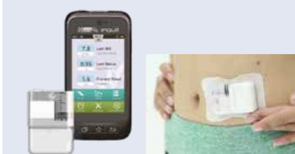
Obr. 1 | Bezdrôtová náplastová inzulínová pumpa Equil obsahujúca personálny dátový manažér a jednotku pumpa/rezervoár. Upravené podľa [3]
