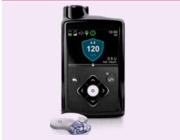
Obr. 3 | Prvý systém s automatickým dávkovaním bazálneho inzulínu na základe merania glukózy CGM systémom (Medtronic MiniMed 670G). Automatické dávkovanie je možné iba pre bazálny inzulín, kým bôlusový inzulín si podáva pacient sám (tzv. hybridný systém)
