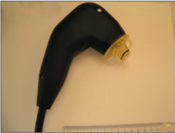
Obr. 1. Vyšetřovací sonda, rukojeť, hlavice, komůrka, která se plní vodou (při vyšetřování vysokofrekvenčním ultrazvukem se nepoužívá sonogel, ale voda).
