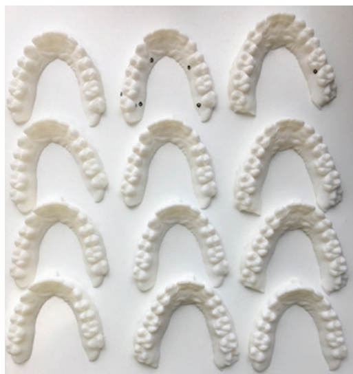
Obr. 1 Vytlačené FDM modely
