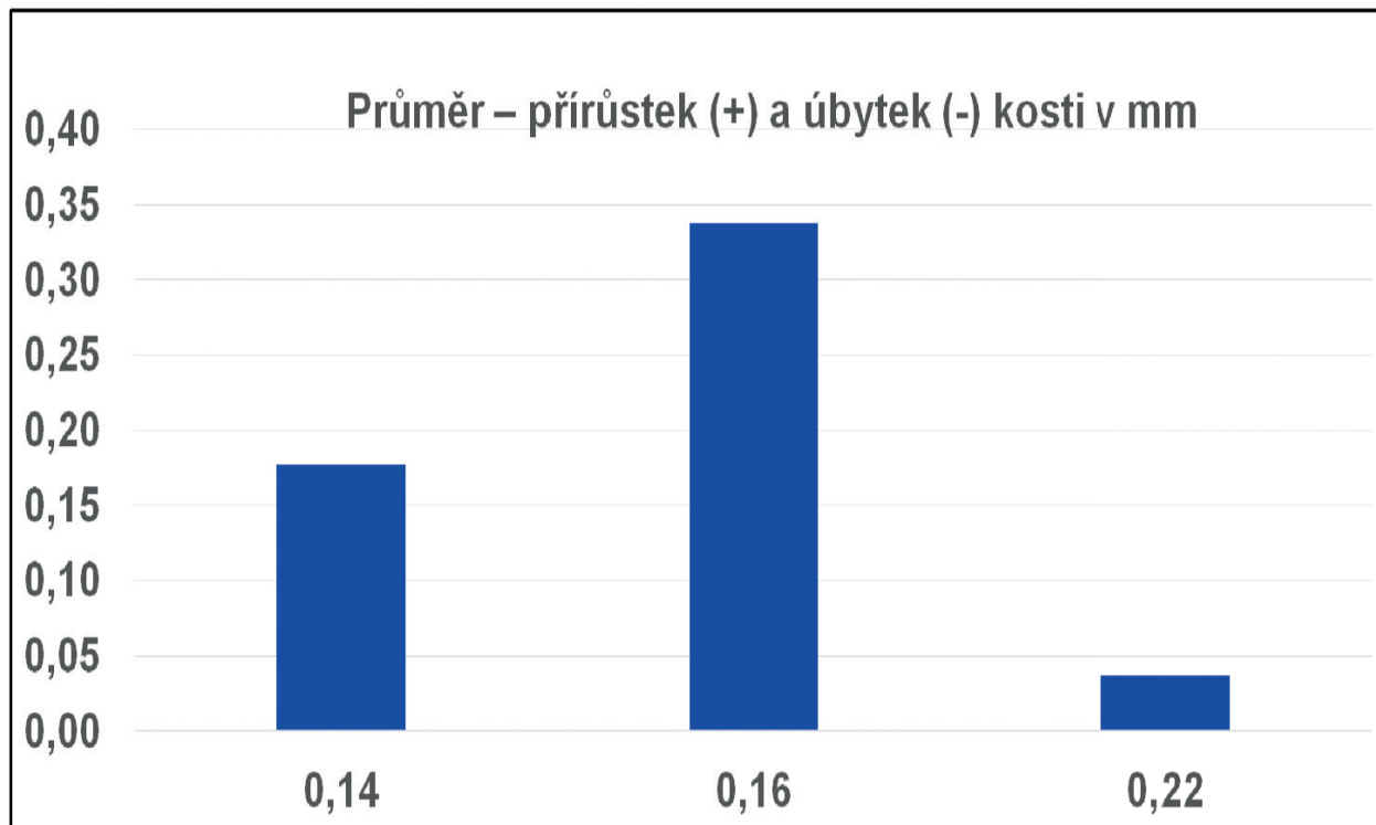
Graf 1 Vliv výšky mikrozávitu na kvalitu oseointegrace (stoupání mikrozávitu implantátů v mm)
