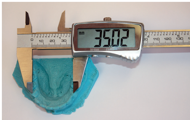
Obr. 3 Měření digitálním posuvným měřítkem na modelu získaném 3D tiskem
