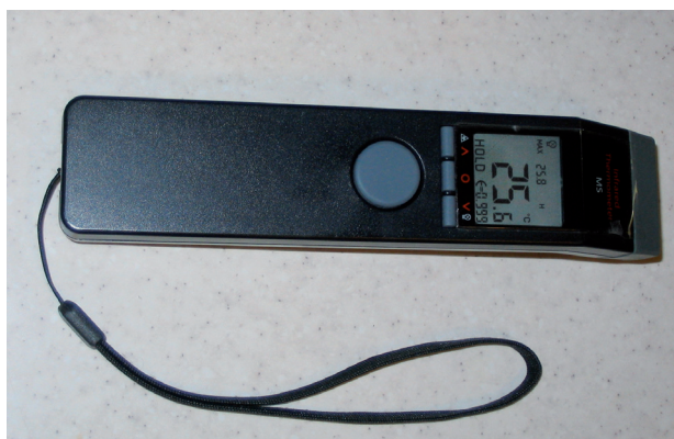
Obr. 1 Bezkontaktní infračervený teploměr GIM 530MS
