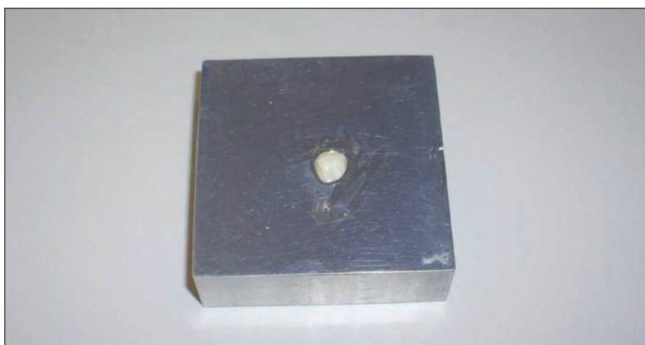
Obr. 2 Sklovinný vzorek fixovaný na kovové destičce
