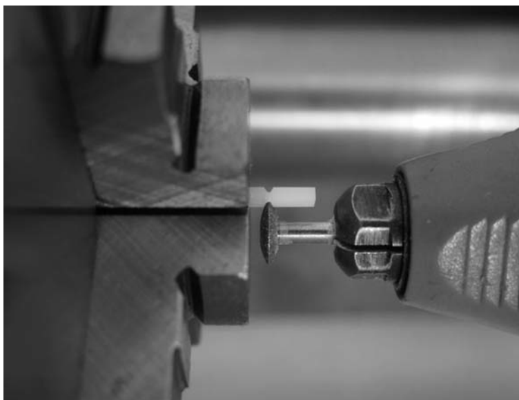
Obr. 2 Úprava průřezu vzorku v místě adhezního spoje
