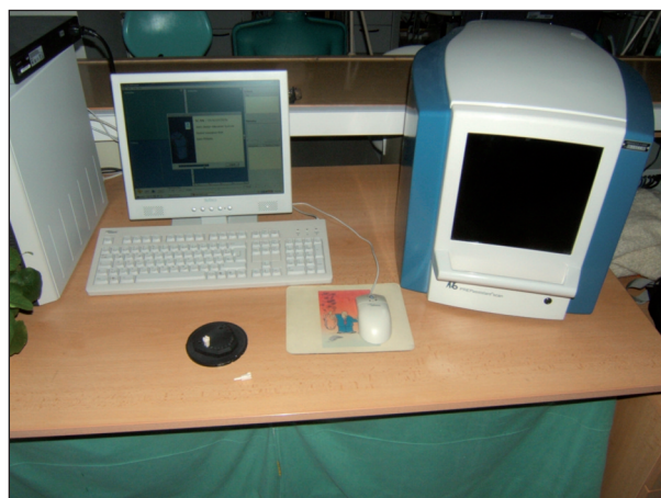
Obr. 1. Systém KaVo PREPassistant.
