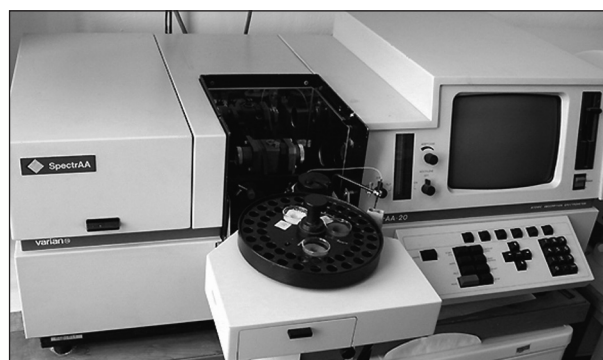
Obr. 3. Atomový absorpční spektrometr SpectraAA-20.
