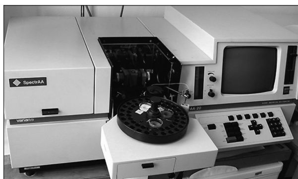
Obr. 3. Atomový absorpční spektrometr SpectraAA-20.
