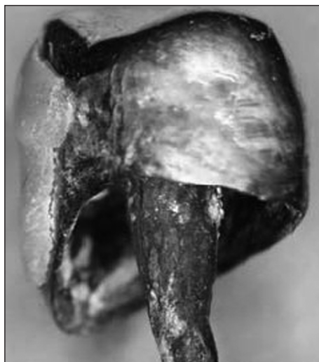
Obr. 2. Koroze kořenového čepu.
