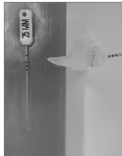
Obr. 7. Fotografie řezu apikální krajinou kořene spolu s dalším kořenovým nástrojem sloužícím ke kalibraci pro vyhodnocení vzdálenosti mezi FA a hrotem kořenového nástroje.
