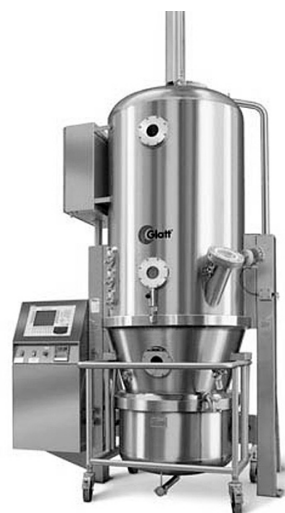
Obr. 4. Fluidní granulátor GLATT (převzato z www.pharmaceuticalonline.com )
