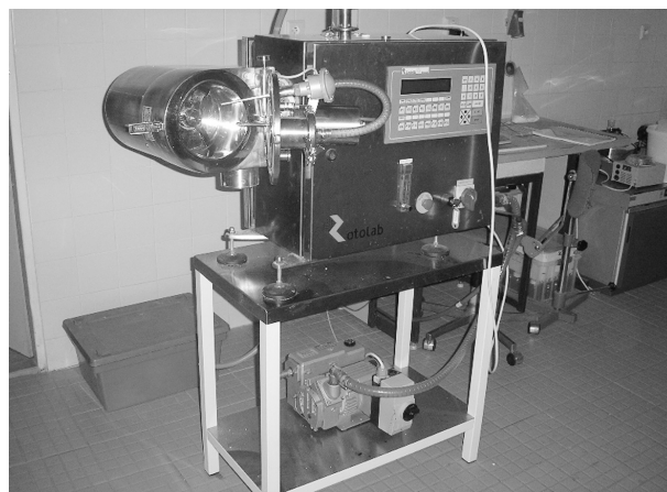
Obr. 2. Jednostupňový granulátor s vakuovým sušením Rotolab ZANCHETTA
