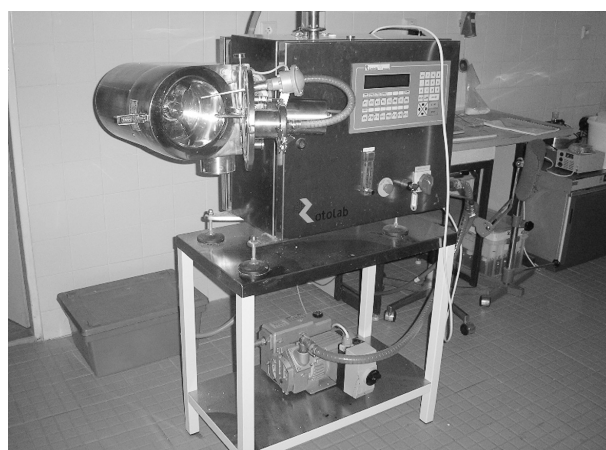
Obr. 2. Jednostupňový granulátor s vakuovým sušením Rotolab ZANCHETTA
