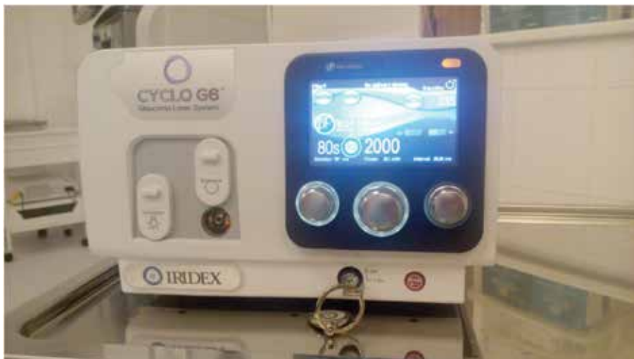
Obrázek 1. Laser Cyclo G6 firmy Iridex. Na monitoru přístroje je vidět nastavení parametrů: délka aplikace 80 sekund, energie 2000 mW
