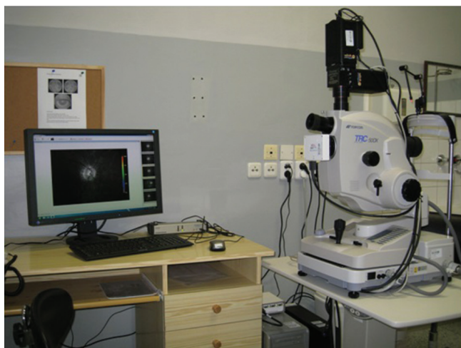
Obr. 1 Duální neinvazivní retinální oxymetr T1 (Oxymap ehf. Reykjavík, Island) připojený na standardní funduskameru (Topcon, TRC – 50 DX, Topcon corp. Tokio, Japan)
