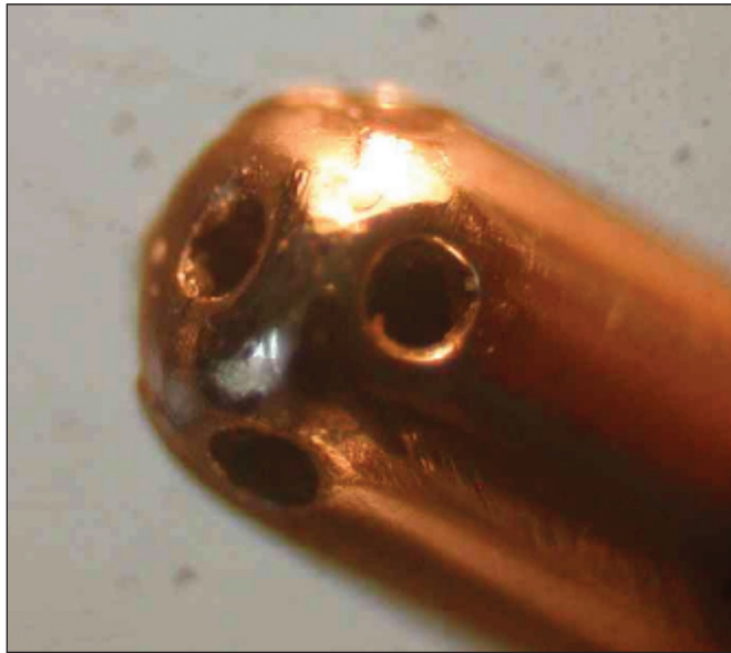
Obr. 1. 5dírková aspirační sonda – detail zakončení s 5 otvory o průměru 0,1mm. Podle našeho návrhu ji vyrobila firma Geuder.
