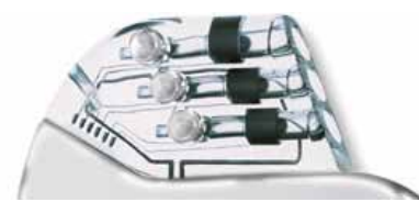
Obr. 1. Anténa v koncovce implantátu zodpovědná za radiofrekvenční přenos dat.
