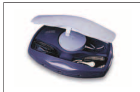
Obr. 9. Pacientská jednotka systému Housecall Plus firmy St. Jude Medical, obsahující náramkové elektrody ke snímání povrchového EKG, radiofrekvenční snímací hlavici a pevnou telefonní linku pro hlasový kontakt s vyškoleným personálem (převzato z internetové prezentace firmy St. Jude Medical: http://www.sjm.com ).
