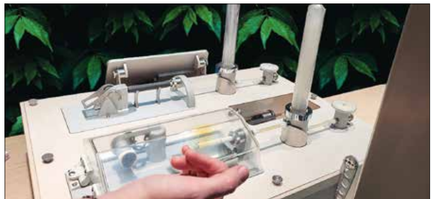
Obr. 2 – Lineární přístroj se dvěma paralelními písty k získání výzkumného vzorku aerosolu z referenční cigarety (vpředu) vs. z nahřívání tabáku (vzadu). [Foto: Jiří Široký]
