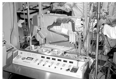
Obr. 6. A – moderní přístroj pro mimotělní oběh Sarns 5000, B – mi-niaturní přístroj pro mimotělní oběh pro novorozence a kojence vlastní konstrukce
