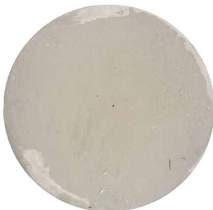
Obr. 10 Filtek Ultimate vystavený kyselému pH po dobu 14 dnů
