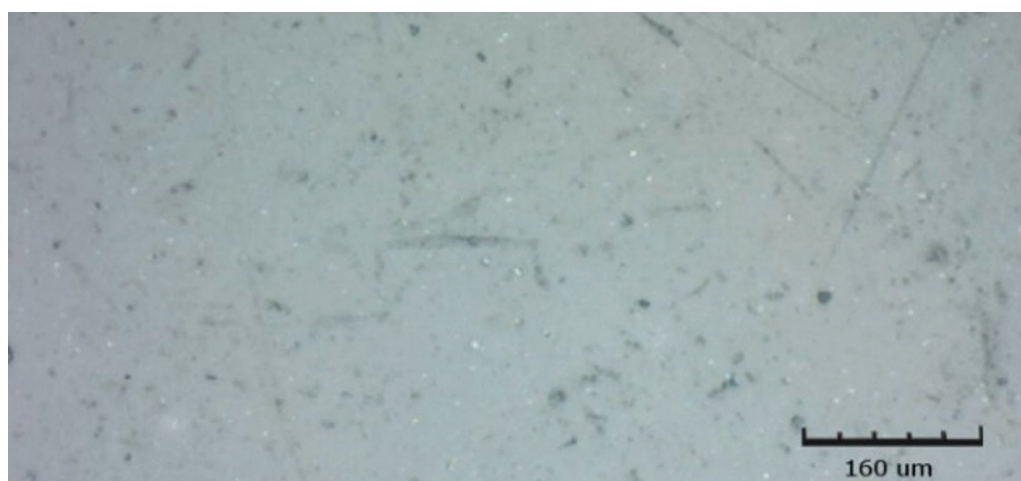
Obr. 12 Filtek Ultimate vystavený kyselému pH po dobu 14 dnů, zobrazeno CLSM
