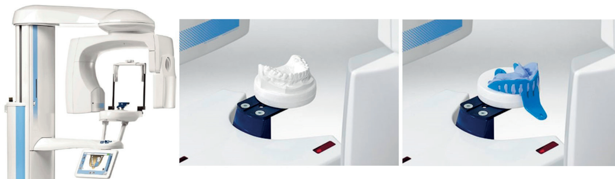
Obr. 2 Objemová data získaná digitalizací pomocí počítačové tomografie na přístroji Planmeca ProMax® 3D (Planmeca, Finsko) (převzato z: http://www.midealtech.com.tw/eng/p2-products-1a.htm ).
