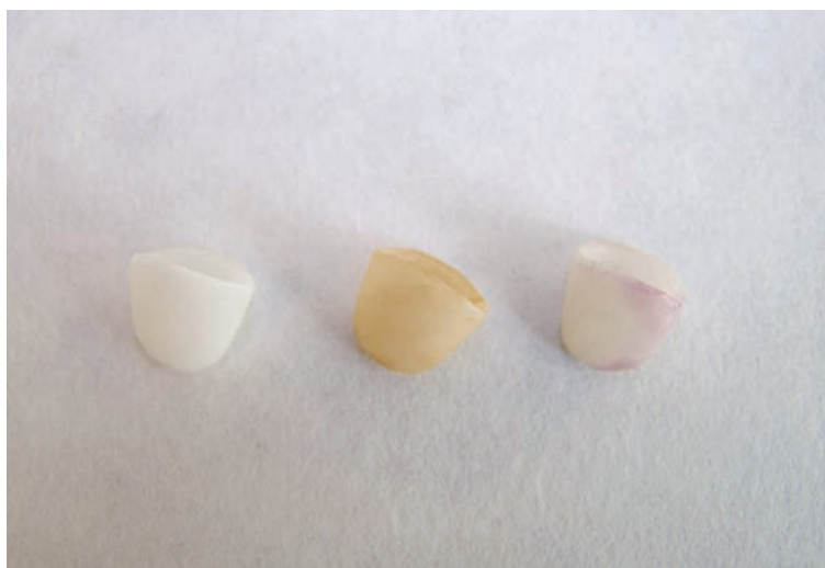
Obr. 3 Změna barvy materiálu In-Ceram Spinell po týdenním korozním testu A – ústní voda, B – Freeway cola, C – červené víno
