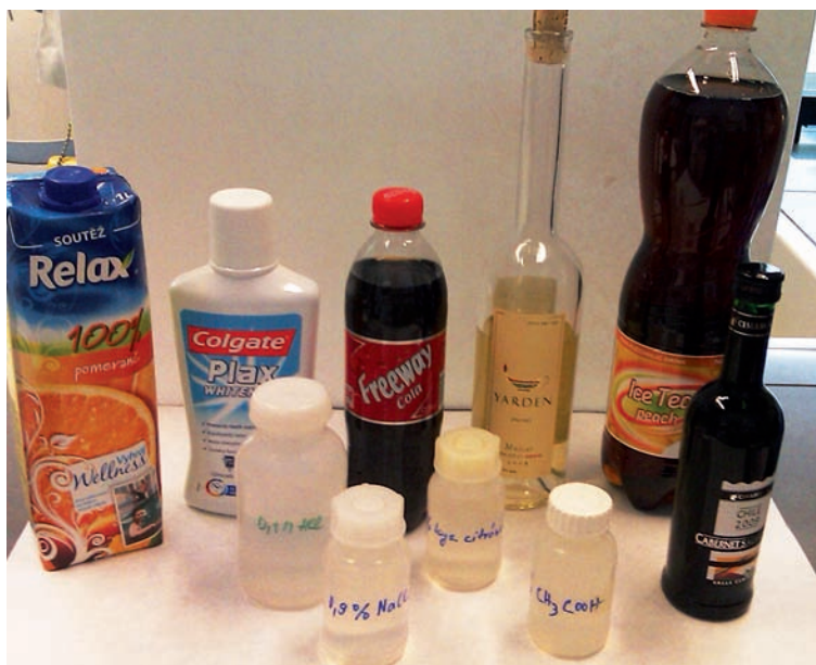
Obr. 2 Nápoje a roztoky používané pro korozní zkoušku
