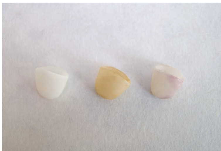
Obr. 3 Změna barvy materiálu In-Ceram Spinell po týdenním korozním testu A – ústní voda, B – Freeway cola, C – červené víno
