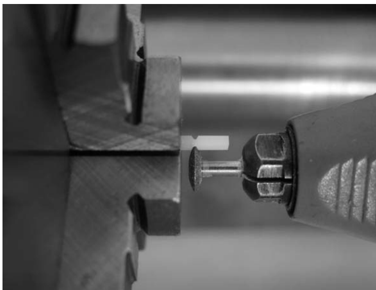
Obr. 2 Úprava průřezu vzorku v místě adhezního spoje
