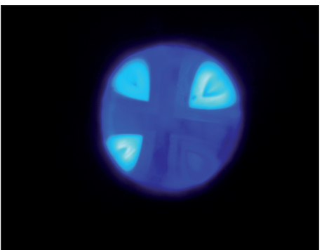
d) Lampa VALO (Ultradent) vybavená třemi typy diod a maximy emise při 405 a 460 nm.
