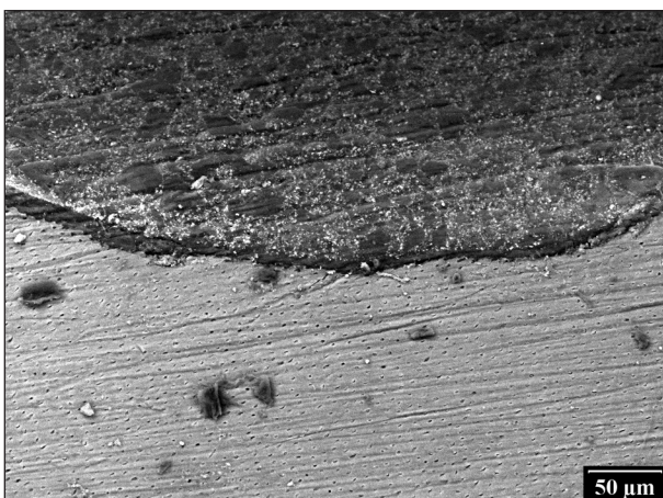
Obr. 6. Kavita preparovaná ultrazvukem (vlevo); mikropraskliny a nerovnosti dna (vpravo).
