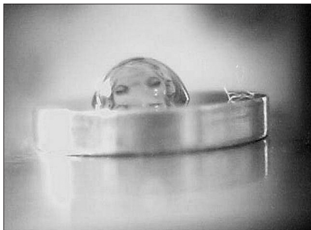
Obr. 3. Fotografie kapky destilované vody o objemu 10 \mu l před měřením kontaktního úhlu na vzorku titanové slitiny.
