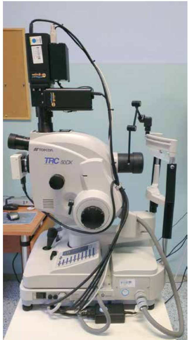
Obrázek 1. Retinální oxymetr Oxymap T1 (černý přístroj nahoře) umístěný na sítnicové kameře Topcon
