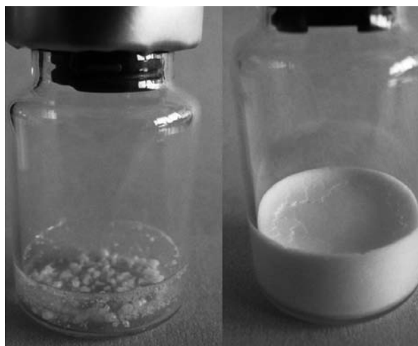
Obr. 1. Zrútený (vľavo) a vzhľadovo vyhovujúci lyofilizát (vpravo)
