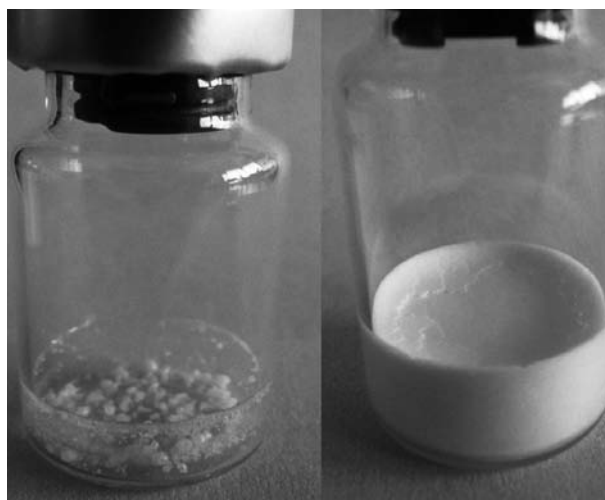
Obr. 1. Zrútený (vľavo) a vzhľadovo vyhovujúci lyofilizát (vpravo)
