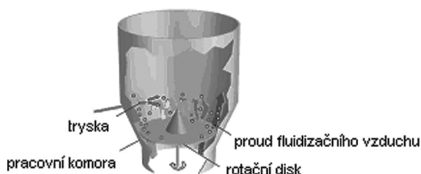
Obr. 5. Zařízení s tangenciálním nástřikem (přepřacováno dle 15) )
